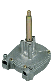
Boîtier Y22 (système fixation rapide du câble)
