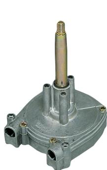
Boîtier Y22 (système fixation rapide du câble)
