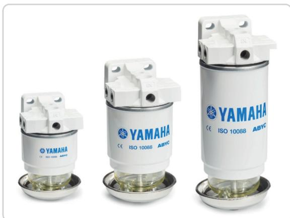
Seule gamme de filtres séparateurs eau/essence du marché entièrement homologuée. Cela est dû à la structure du bol au bas du filtre qui est entièrement ignifugé et répond à la norme CE, ISO 10088 et ABYC. Cela signifie que ces filtres peuvent être également utilisés partout dans le monde. Capacité de filtration : 10 microns.
